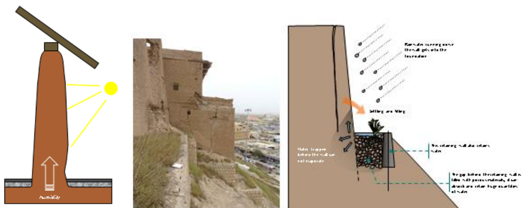
1-rasm. Gilxomashyoli me'moriy yodgorliklarni atmosfera ta'siridan emirilishi
